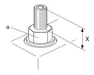
2 Schrauben Sie die neue Dichtmutter (a) ein. Blockieren Sie die Stellschraube (b) während Sie die Dichtmutter festziehen.
