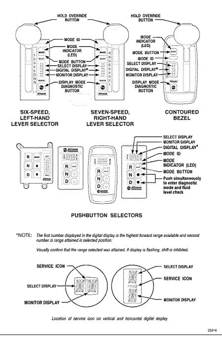
Figure 5–4. TYPICAL ALLISON 4<sup>TH</sup> GENERATION SHIFT SELECTOR
