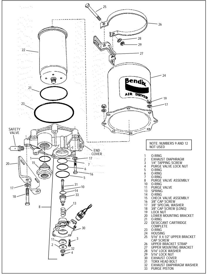
FIGURE 7 - AD-9<sup>™</sup> AIR DRYER ASSEMBLY
