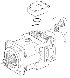
5 Ziehen Sie die fünf Befestigungsschrauben an.
