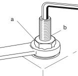
Anziehdrehmomente für Seal-Lock Dichtmuttern (nach N 02.100)
