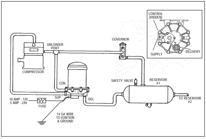
FIGURE 2 - AD-9™ AIR DRYER CHARGE CYCLE
