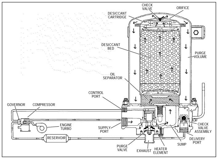
FIGURE 2 - AD-9<sup>™</sup> AIR DRYER CHARGE CYCLE
