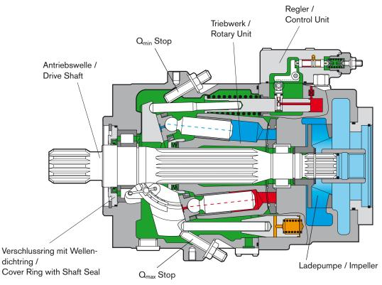
$Q_{min}$  Stop /  $Q_{max}$  Stop: Anschlag für minimalen/maximalen Schwenkwinkel.
