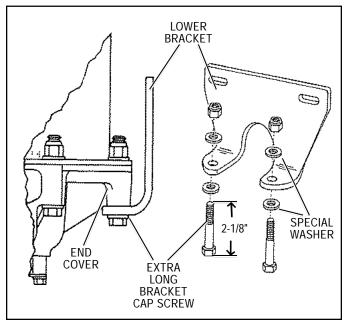
FIGURE 9 - LOWER BRACKET INSTALLATION
