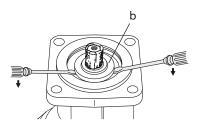
4 Entfernen Sie den Wellendichtring (c) aus dem Verschlussring (b) sowie den O-Ring (d) aus dem Gehäuse.
