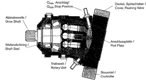
Ansicht Anschlussplatte mit Verstellungen/ View Port Plate with Controllers
