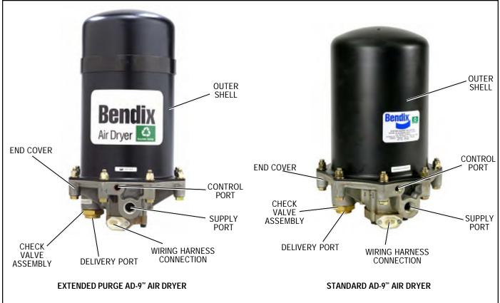
FIGURE 1 - AD-9<sup>™</sup> AIR DRYER MODELS
